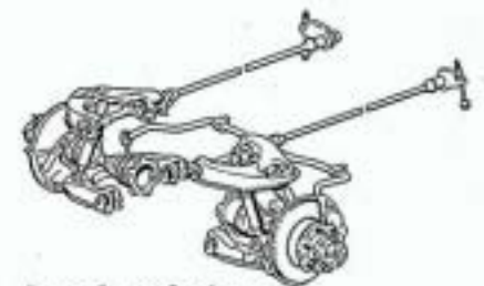
Doppelquerlenker-Vorderachse mit oberliegenden Torsionsfedern
